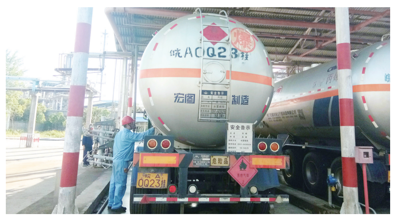
日前,安庆石化危化品两辆罐车卸卸现场安全管控。该公司岗位职工认真做好夏季防暑降温工作,对两辆罐车卸卸现场进行喷淋降温。同时避开高温时段进行两辆罐车卸卸,严把两辆罐车卸卸安全关。 通讯员 曹国萍 摄
