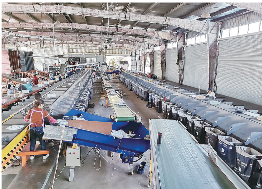
10月15日,申通快递安庆分拣中心的自动化快递分拣线上,快递正有条不紊进入分拣道口。智能分拣,提高了效率,也减少了装卸磕碰。
