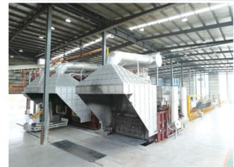
司也能看到。车间内机器飞转,机声轰鸣,废弃物经过原材料破碎、分选进入双室炉内的漩涡井进行熔炼,成为一个个铝制品。全智能自动化生产线可节约50%以上的人力资源成本,效率提高30%以上,同时降低能耗、铝损、污染物
