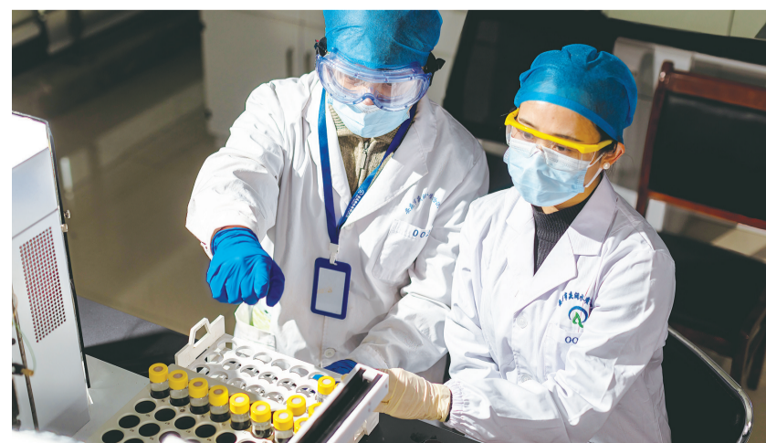
12月9日,水质检测人员正在用吹扫捕集气相色谱法测定水中挥发性有机物。通讯员 颜春骏 摄
