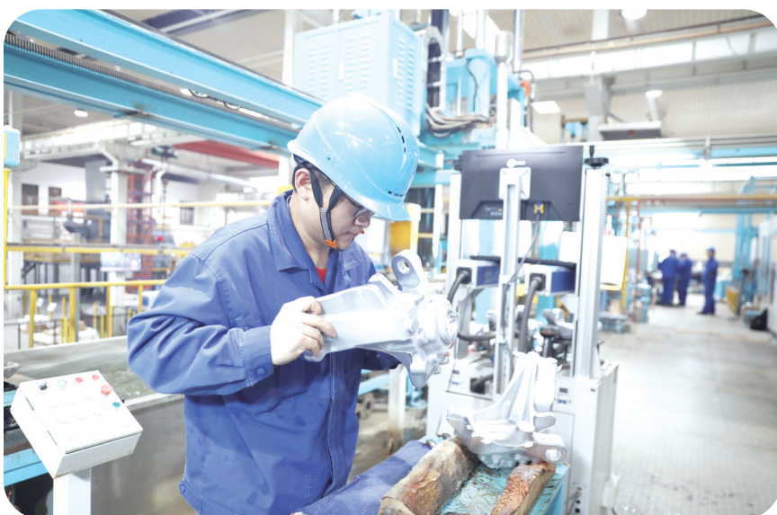
2月12日,安庆经开区安簧股份有限公司压铸车间工人正在检查铝合金转向节。全媒体记者 徐火炬 通讯员 姚志超 摄
