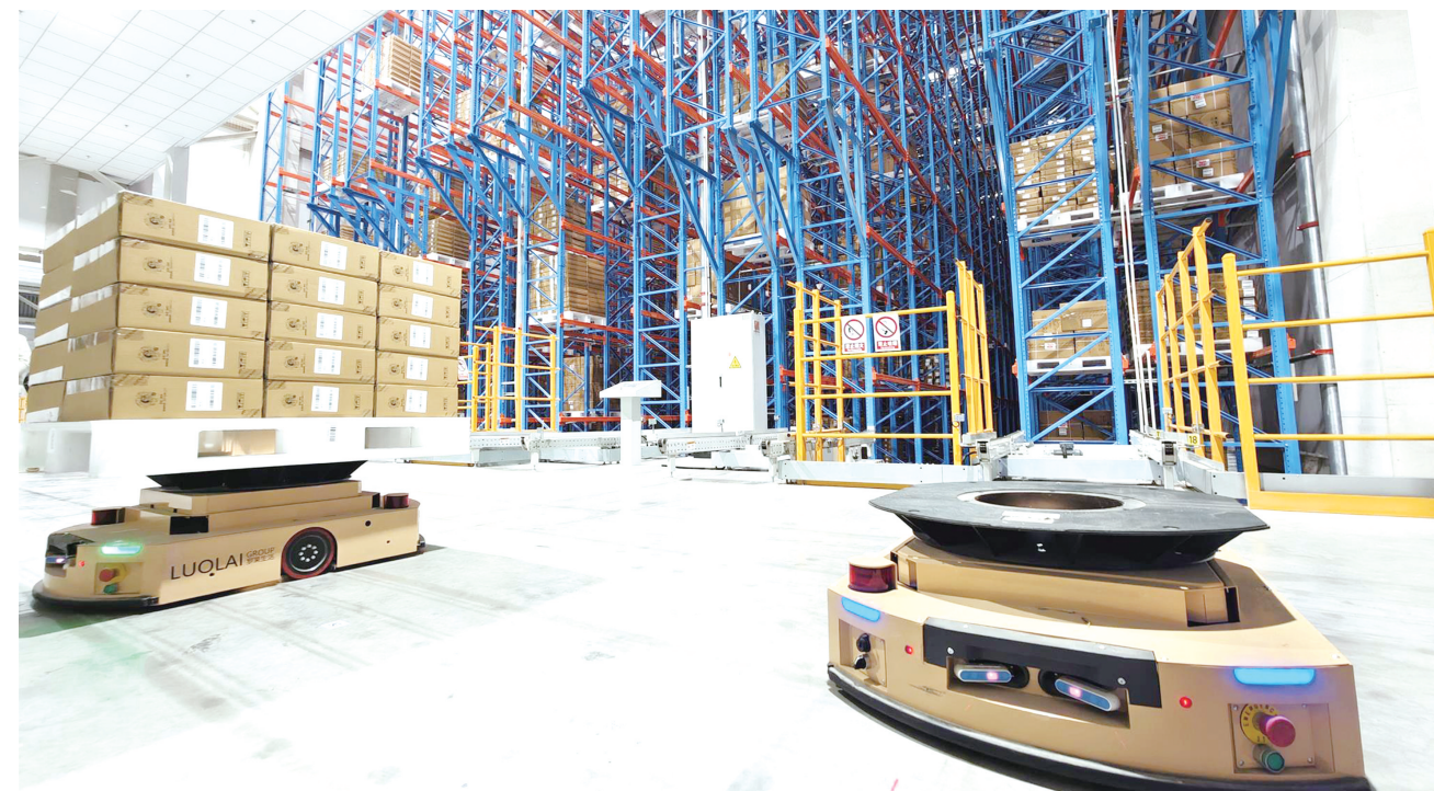
南通市罗莱家纺产业园智能立体仓库,工业搬运机器人按照程序规划路线来回穿梭,自动搬运物料。(全媒体记者 江露露)
