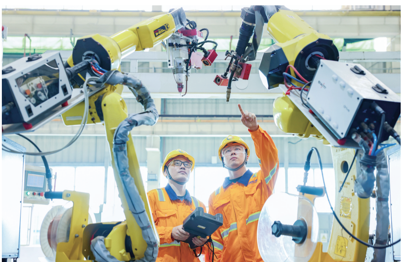
技术人员在调试深水油气装备工艺管线智能生产线的焊接机械臂。
