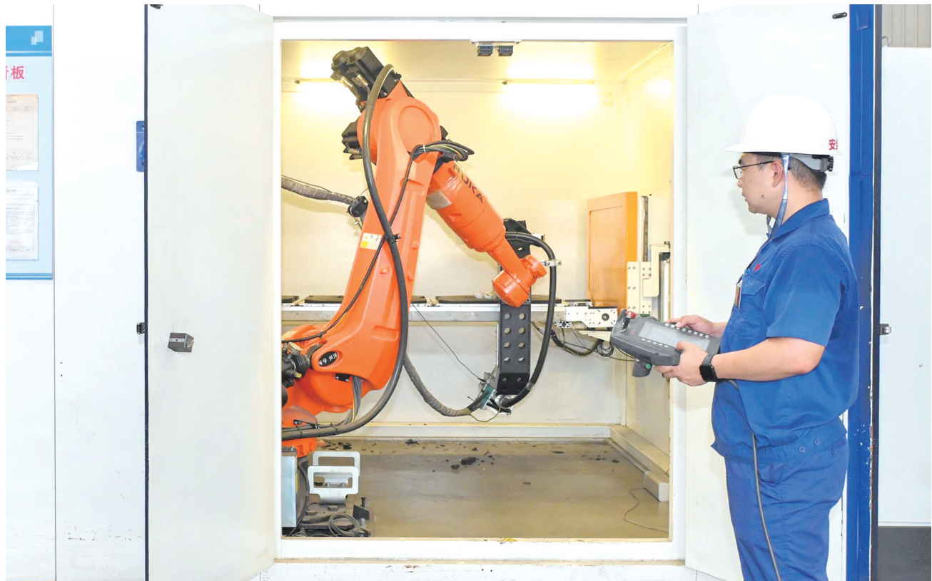
7月17日,安徽安菱机械股份有限公司铝合金压铸车间内,技术人员手持示教器调试X光检测工位压卡工业机器人,开展工件自动化探伤作业。 全媒体记者 路欣 摄
