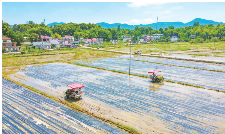
5月28日,岳西县温泉镇,水稻覆膜插秧一体机在农田里往来穿梭,一次性完成全生物降解地膜铺设与插秧作业。
